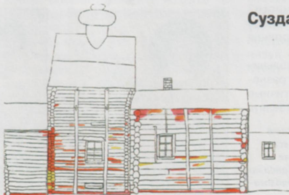
Рисунок церкви в селе Ковда с отмеченными местами прогнилости
